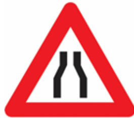
Señal de advertencia de peligro por estrechamiento de la calzada (P-17)
